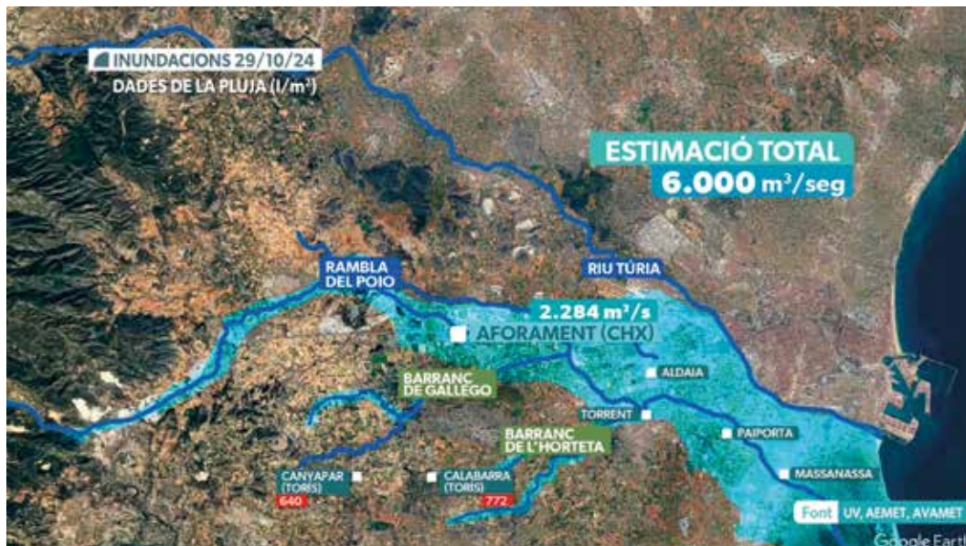
Fig. 6. Contribucions al gran tsunami que assolà l'Horta Sud dels barrancs de Gallego i de l'Horteta (que reberen entre 600 i més de 700 l/m² a les respectives capçaleres) i que desembocquen en la rambla de Poio. (Dades UV, AVAMET i AEMET i grafisme d'À Punt)
