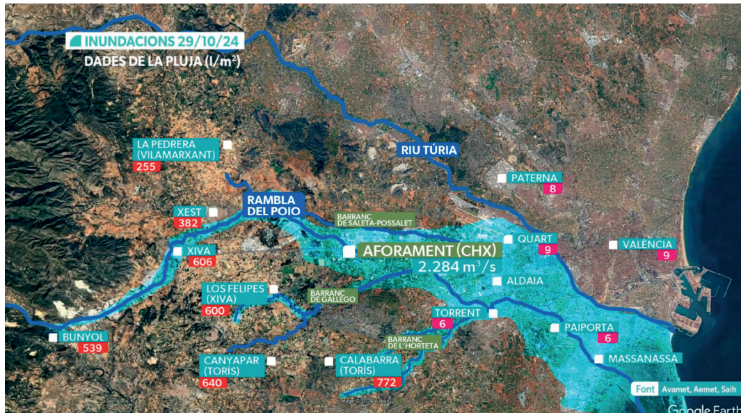
Fig. 5. Representació de les pluges registrades els 20 d'octubre per la xarxa d'AVAMET i AEMET (en roig) que s'abocaren a la rambla de Poio i ubicació de l'estació d'aforament del SAIH, que mesurà més de 2.000 m³/seg abans de deixar de transmetre dades. El descomunal volum d'aigua arribaria a l'Horta Sud, on pràcticament no havia plogut i on hi hauria gran part de les víctimes mortals (grafisme d'À Punt).
