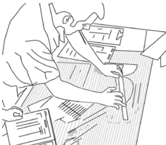
Figura 3 El posicionamiento del cuerpo del oficial de navegación mientras corrige ligeramente en sentido horario la segunda LDP. El pulgar izquierdo actúa como pivote mientras la mano derecha desliza ligeramente el brazo del trazador de brazo hacia el cuerpo del oficial.
