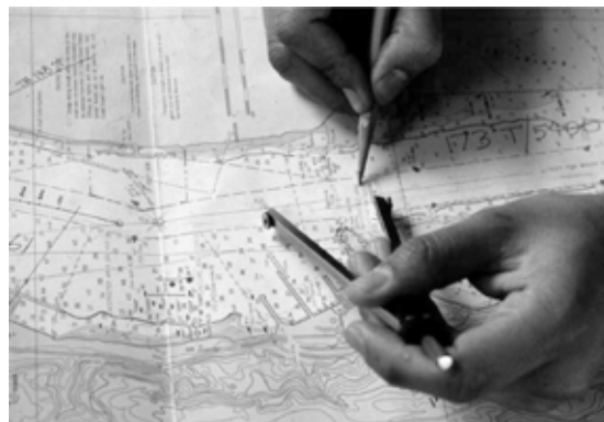
Figura 1 Utilización del compás para tomar la distancia entre dos estimas sucesivas.
